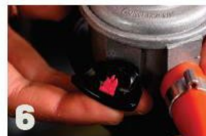
6 Før bruk må gassventilen åpnes, rød flamme opp
