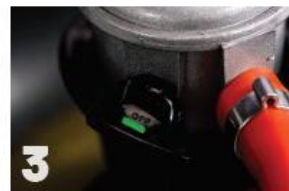
3 Pass på at ventilen er stengt før festing
